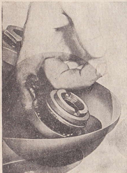
Obr. 41. Mazání kuliček v hlavě rámu
