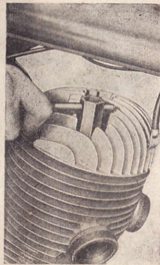
Obr. 36. Sejmutí hlavy válce — 250
